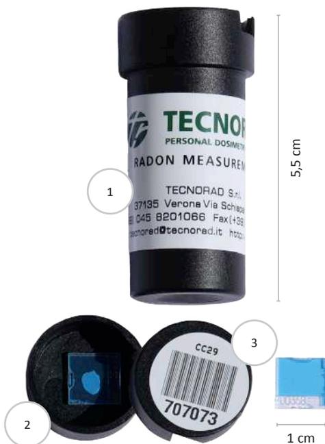
La misurazione termina quando il sensore viene rimosso e restituito il più velocemente possibile al laboratorio TECNORAD®. È importante ricordarsi di annotare data e ora di inizio e fine esposizione ed il luogo di posizionamento.
