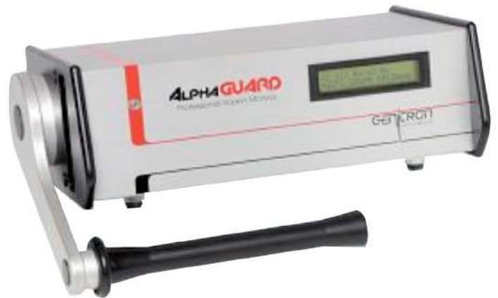
**AlphaGUARD** è uno strumento portatile compatto per la determinazione in continuo della concentrazione del Radon e della relativa progenie, oltre ai parametri climatici, in ambienti di lavoro o abitativi. La misura viene ripetuta e registra automaticamente in memoria ogni 10 minuti. **AlphaGUARD** può funzionare in maniera autonoma con batterie oppure con alimentazione di rete.
